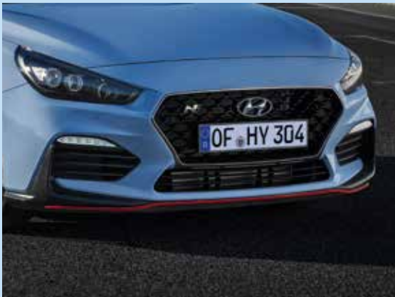
Die tiefergelegte Karosserie, der tiefergezogene Kühlergrill und die Frontlippe mit roter Zierleiste 4 .
