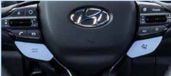
Tasten für Drive Modes (Eco/Normal/Sport) und N Modes (N Modus / N Custom).
