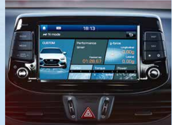
Auf dem Navigations-Display 1 werden auch spezielle Informationen wie G-Kräfte, Drehmoment, Rundenzeiten und Fahrmodi angezeigt.
