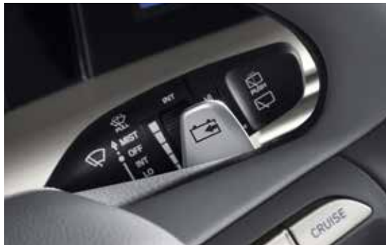
Schaltwippe zum Einstellen des Rekuperationslevels (Rückgewinnung von Energie aus dem Bremsvorgang)
