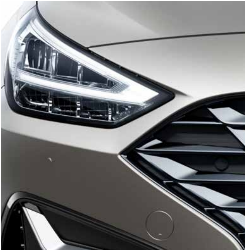
Schlanke neue Voll-LED-Scheinwerfer 1 mit integrierten V-förmigen LED-Tagfahrlichtern.
